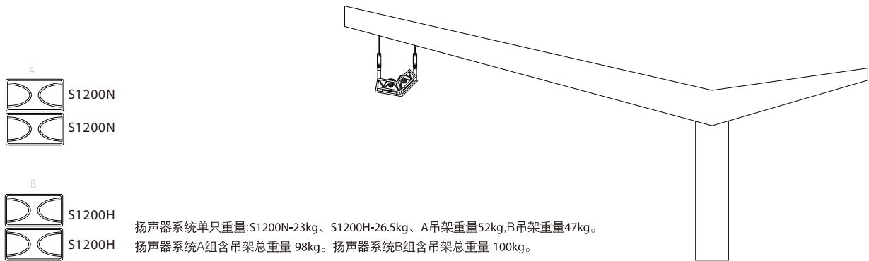
S1200N S1200N S1200B S1200H S1200H 扬声器系统单只重量:S1200N-23kg、S1200H-26.5kg、S1200B-24.5kg。 吊架重量76.5kg。 扬声器系统组合吊架总重量: 200kg。
